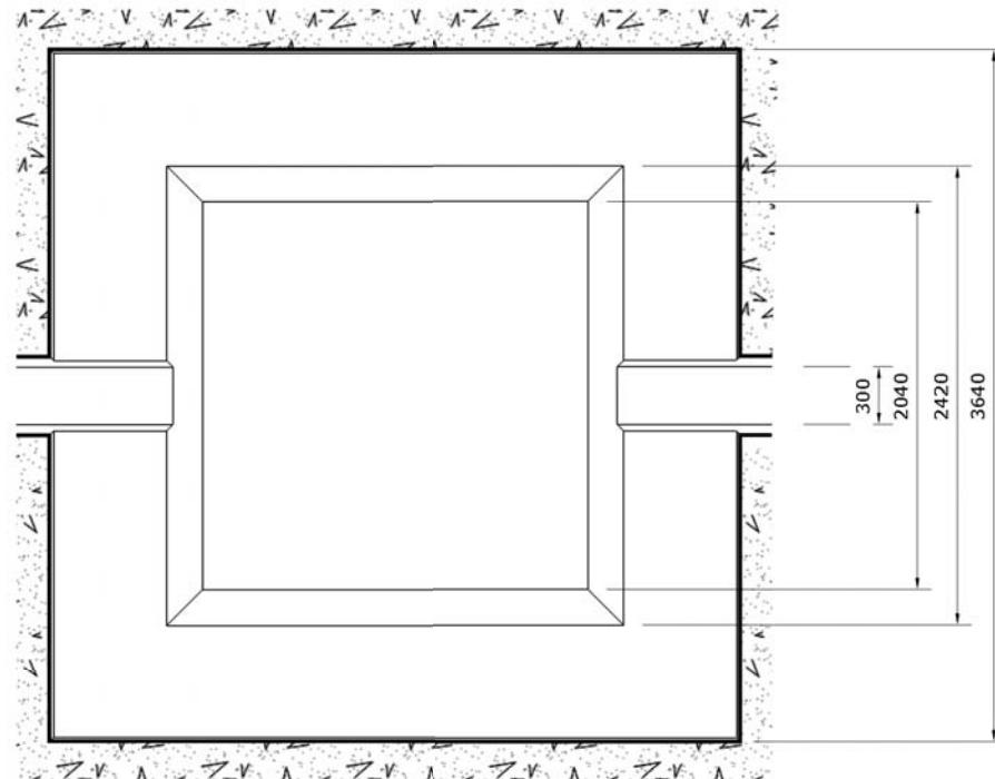
Рисунок 2.3. Чертеж котлована для установки ЛОС АНА 100. Разрез.
