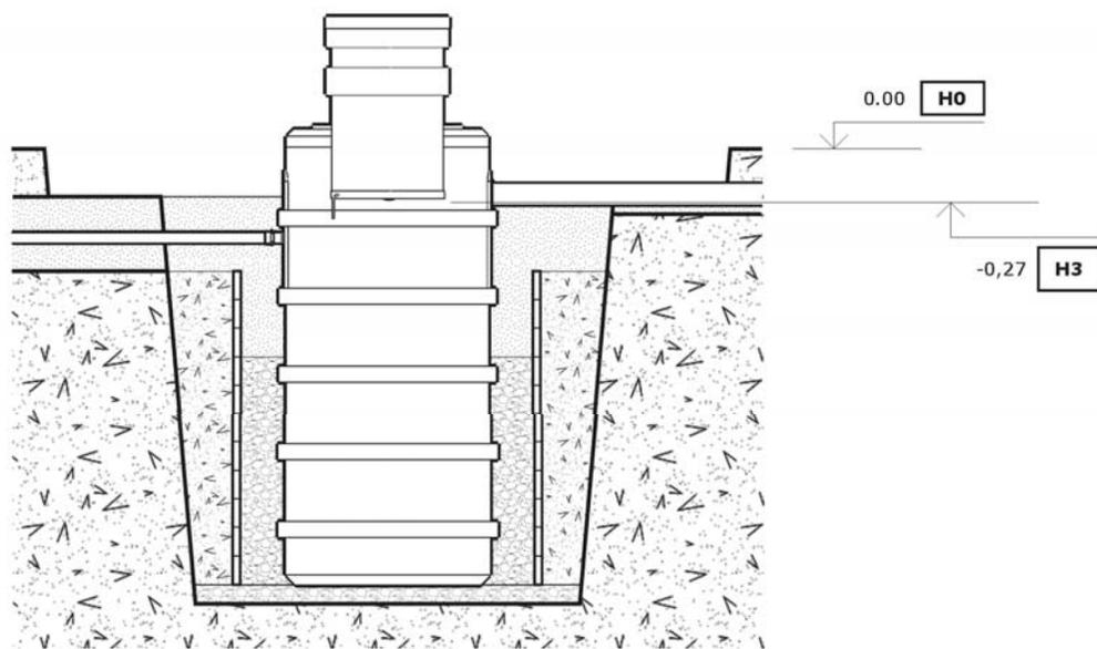
Рисунок 2.11. Укладка гидрофобного утеплителя, засыпка песка, устройство газона вокруг ААТ АНА 880.
