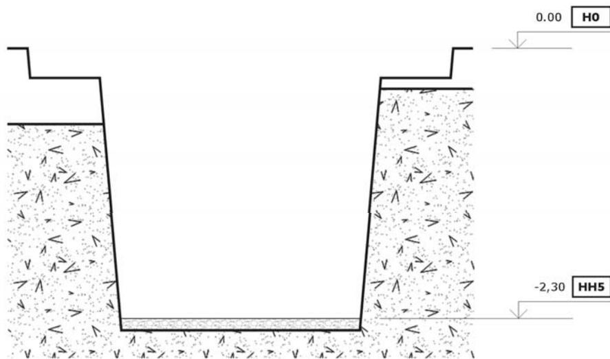
Рисунок 2.5. Установка опалубки в котловане для монтажа ААТ АНА 880.
