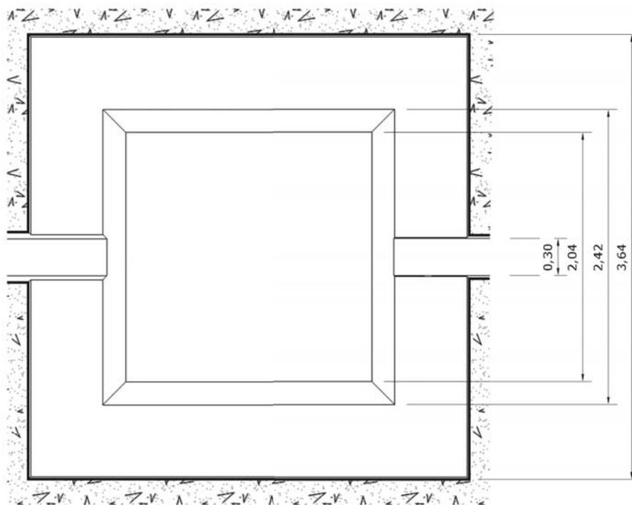
Рисунок 2.3. Чертеж котлована для установки ААТ АНА 880. Разрез.
