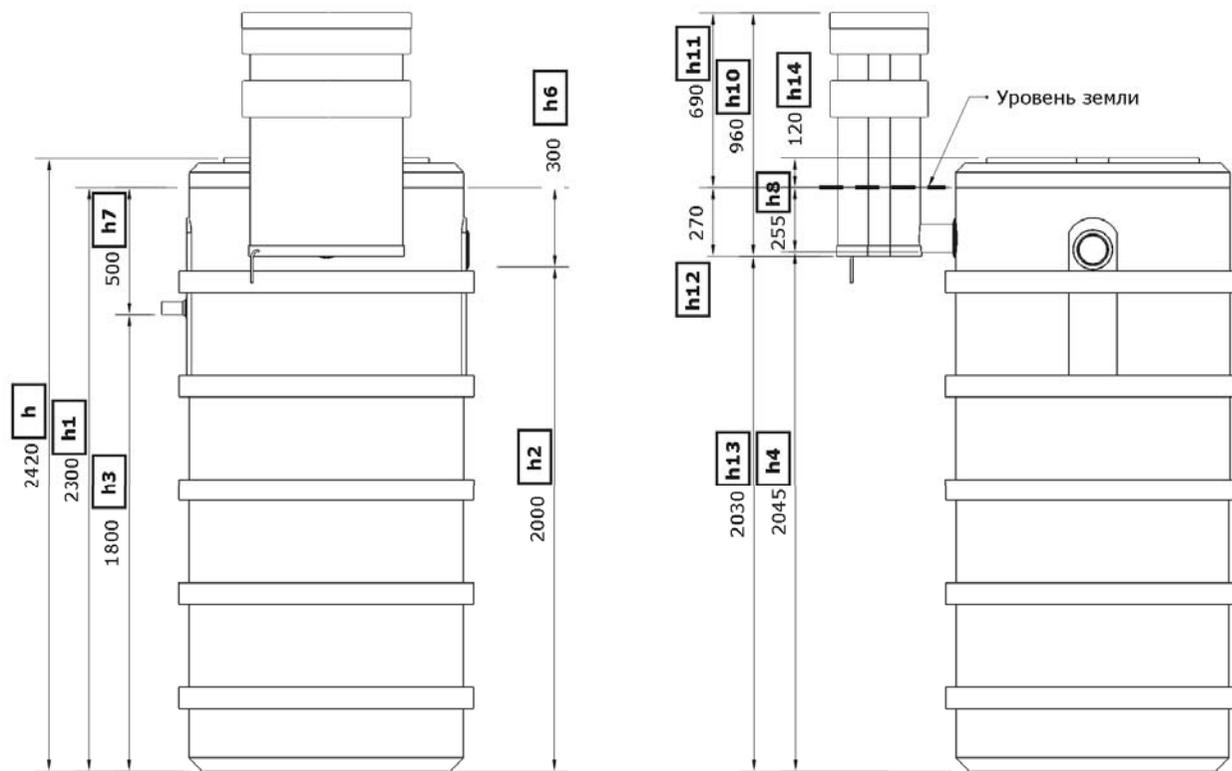
Рисунок 2.2. Чертеж опалубки для ААТ «АНА» Серии 880
