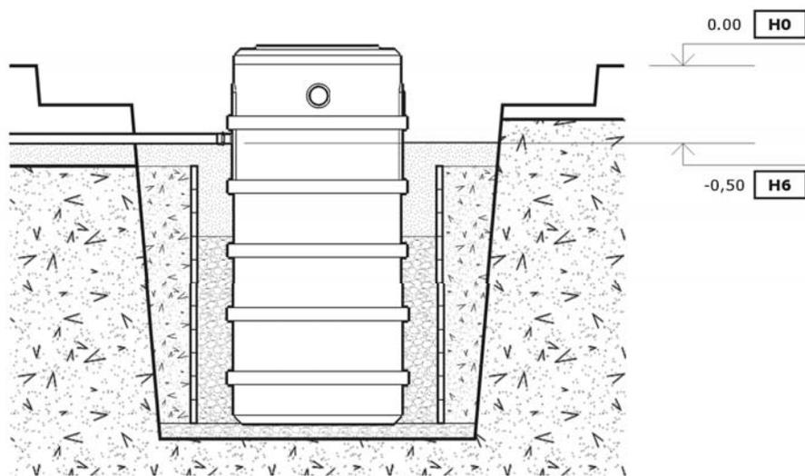
Рисунок 2.9. Засыпка песка, монтаж технологического канала, при монтаже ААТ АНА 880.
