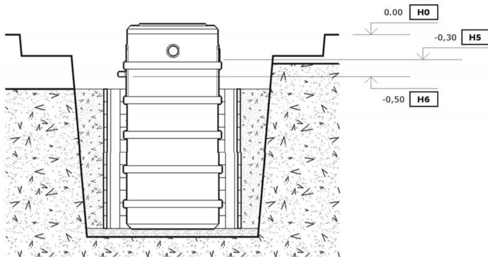
Рисунок 2.7. Засыпка ЦПС при монтаже ААТ АНА 880.
